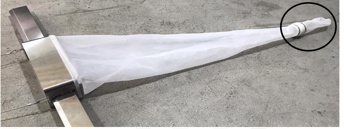
řekil 3.4. Manta kepeřesinin uç kısmından bulunan, toplanan örneklere rahat řekilde numune kaplarına alınmasını sađlaması için sökülebilen kısmı
