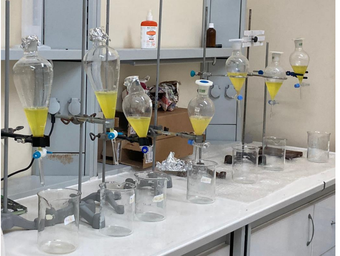
Şekil 3.9. Yoğunluk ayırımında kullanılan armudi ayırma balonları
