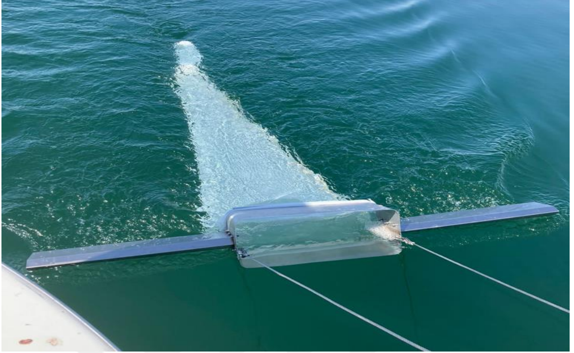
Şekil 3.3. Yüzeyde bulunan MP örneklerinin toplanması için kullanılan manta kepçesi cihazı
