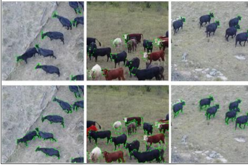
Şekil 2.12. Sığır algılama ve sayım algoritması (Xu vd., 2020)
