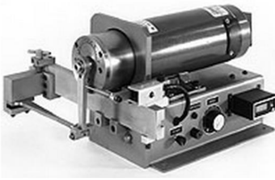
Resim 2.8. Tekrarlı Eğme Yorulma Makinesi (Kaynak: Kalluri vd., 2000)
