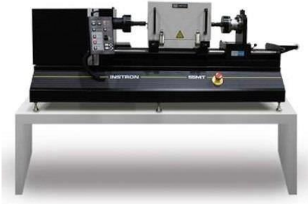
Resim 2.11. Burulma Yorulma Makinesi (Kaynak: Instron, 2024)
