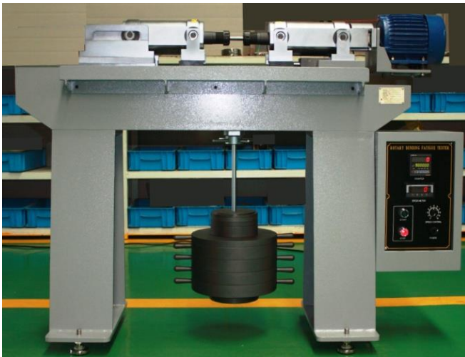
Resim 2.7. R. R. Moore Dört Noktalı Dönel Eğmeli Yorulma Makinesi (Kaynak: Gunt, 2024)
