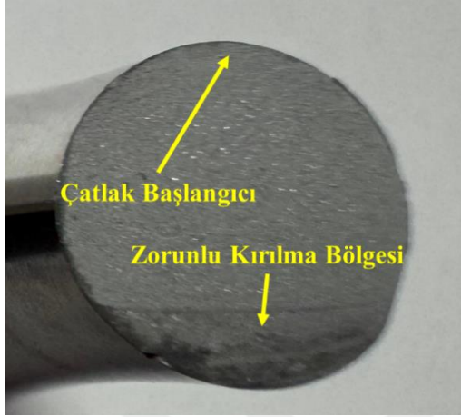
Resim 4.2. Y ksek Y kleme Altında Yorulma Kırığı
