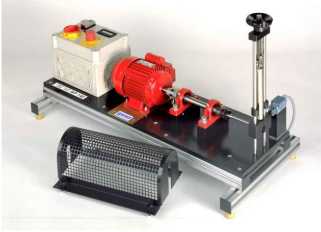
Resim 2.6. Dönel Eğmeli Ankastre Tip Yorulma Makinesi (Kaynak: Gunt, 2024)
