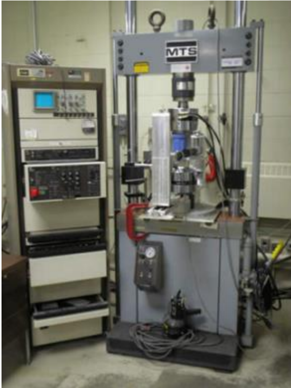
Resim 2.10. Servo Hidrolik Yorulma Makinesi (Kaynak: Dang vd., 2024)
