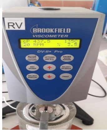
Şekil 4.5. Dönel Viskozimetre Deneyi Yapılışı
