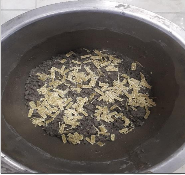
Resim 3.5. Aramid lif takviyeli polimer atık ile harcın karıştırma makinesi içindeki hali
