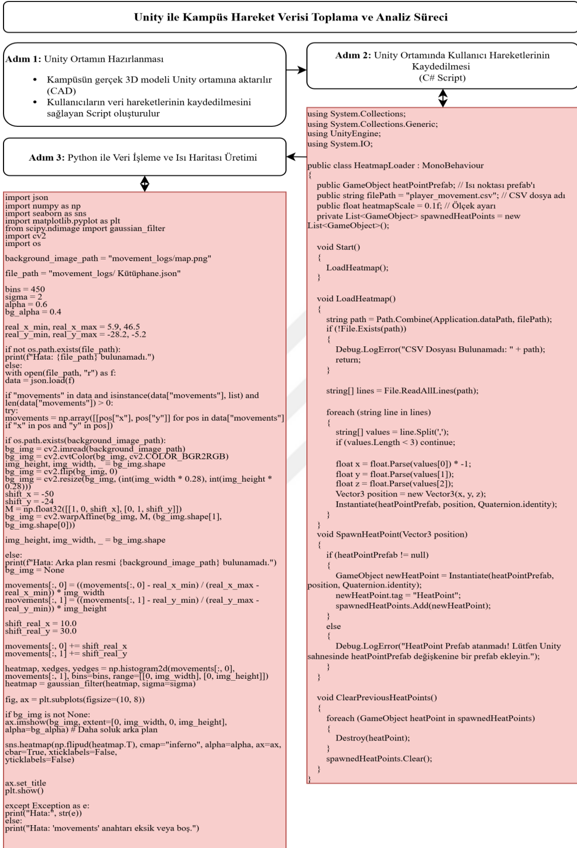
Şekil 3.12. Unity ve Python ile Kampüs Hareket Verisi Toplama ve Analizi Süreci (Örnek Kod)
