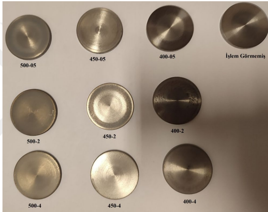
Şekil 4.4. Plazma nitrürleme uygulanan numuneler ve işlem görmemiş numune.
