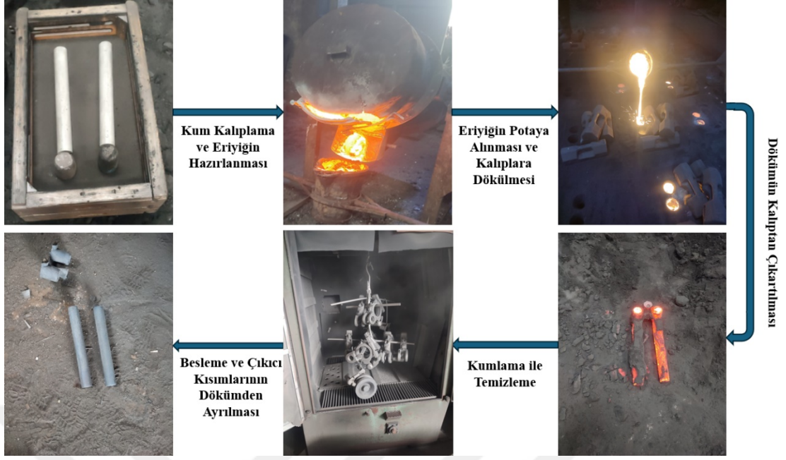
Şekil 4.1. Döküm çubukların üretim aşamaları.
