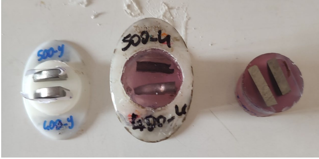
Şekil 4.7. Numunelerin bakalite alınması işlemi.
