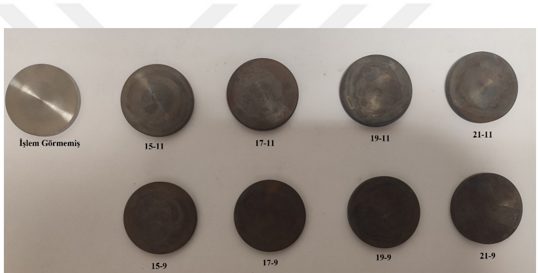
Şekil 4.5. İndüksiyon uygulanan numuneler ve işlem görmemiş numune.
