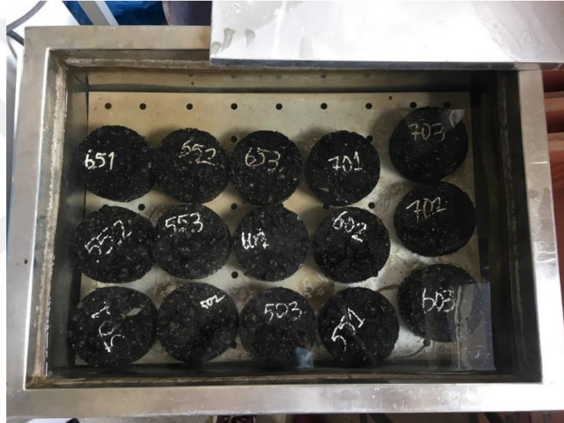
řekil 4.10. Kalıptan ıkarılarak 60  C suda bekletilen numuneler
