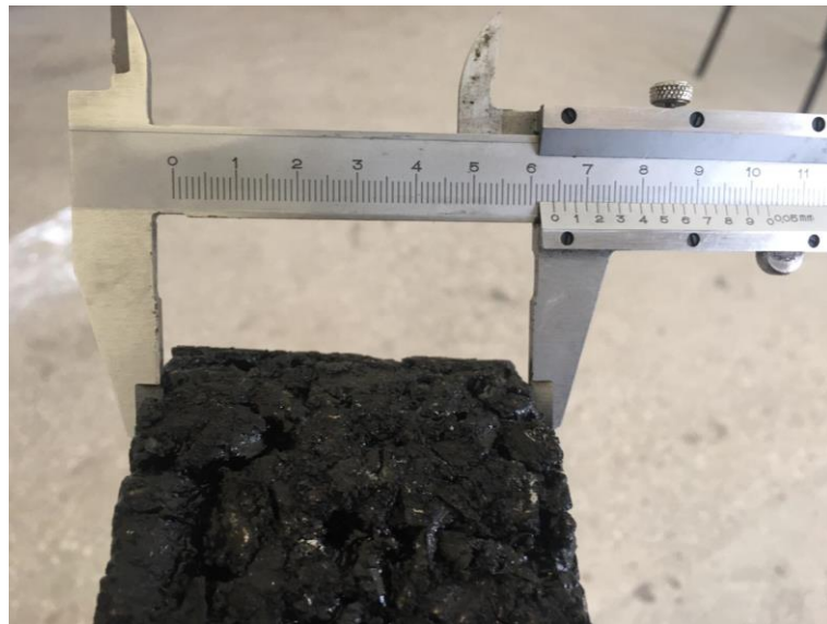
Şekil 3.5. Kumpas ile yükseklik ölçümü
