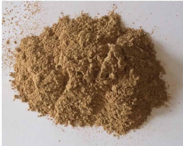
Şekil 4.8. Çalışmada kullanılan genleştirilmiş vermikülit tozu
