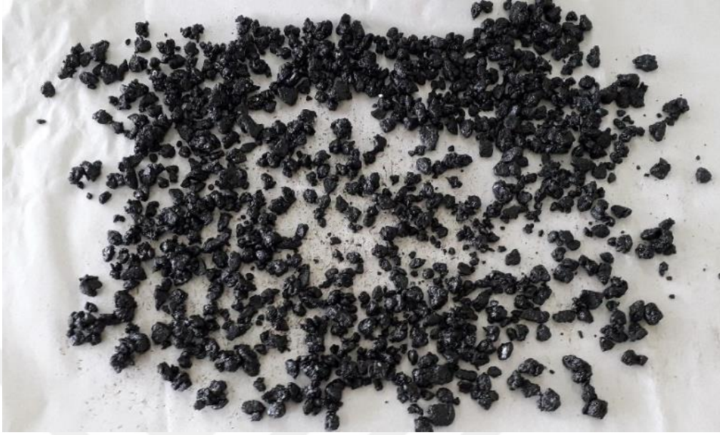
Şekil 4.11. Maksimum teorik özgül ağırlık hesabında kullanılan parçalara ayrılmış bitümlü karışım
