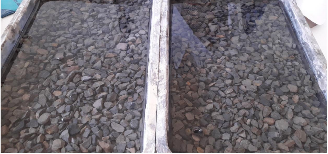
Şekil 4.2. Su dolu tepsi içerisinde bekletilen kaba agrega
