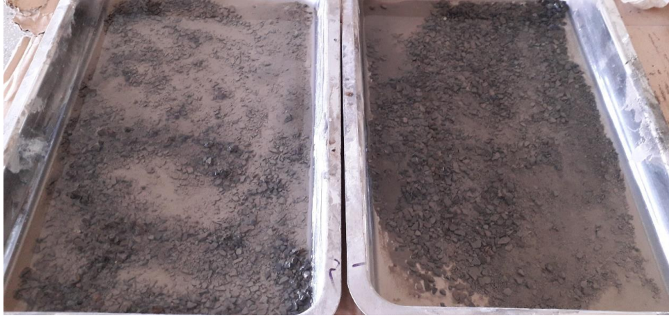
Şekil 4.3. 24 saat suda bekletilen ince agrega
