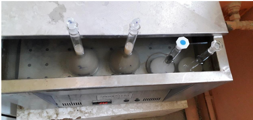
Şekil 4.4. 25°C Su banyosundaki ince ve filler agrega numuneleri
