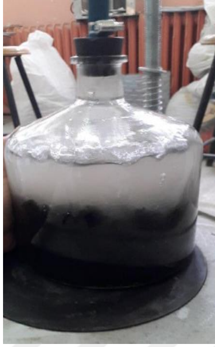
Şekil 4.12. Beherde bulunan karışım ve su üzerine vakum uygulanması
